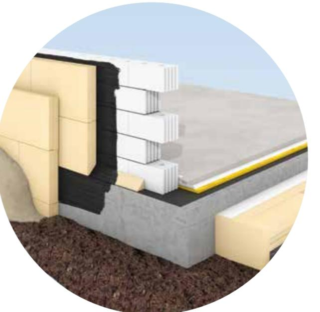
ustvarja prijetno klimo in pomaga pri preprečevanju strukturnih poškodb, kot je na primer pojav plesni. Če je izvedena potrebna topotna izolacija gradbenih elementov z zunanjé strani na stiku z zemljijo, torej na zunanjé strani hidroizolacijskega sloja, govorimo o izolaciji konstrukcij v zemlji.
