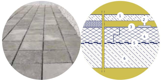
Glede na tlačne obremenitve so na voljo različne plošče iz ekstrudiranega polistirena URSA XPS (tehnični podatki se nahajajo na strani 23). Med sloj prodca in plošče iz ekstrudiranega polistirena URSA XPS je potrebno namestiti paroprepustni filc iz umetnih mas z gramaturo pribl. 120 g/m<sup>2</sup>.
