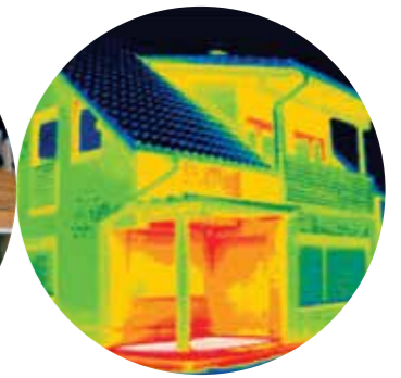
Slika prikazuje pogled s termovizijsko kamero, ki nam pomaga poiskati in oceniti toplotne izgube na objektu.
